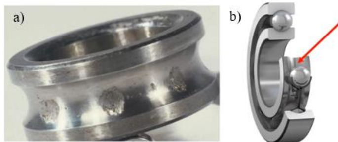
8 pav. Vidinis guolio žiedas: a) plastinės deformacijos nuo perkrovos, b) bendras guolio vaizdas [14]
