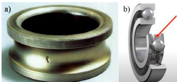
4 pav. Vidinis guolio žiedas: a) po paviršiumi inicijuotas atskilimas, b) bendras guolio vaizdas [14]
