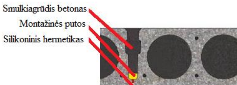
5.3.4. pav. Tarpas tarp perdangos plokščių užsandarinimas
