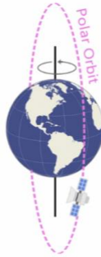
20 pav. Saulei sinchroninė (poliarinė) orbita – palydovų skriejimo trajektorija [59]
