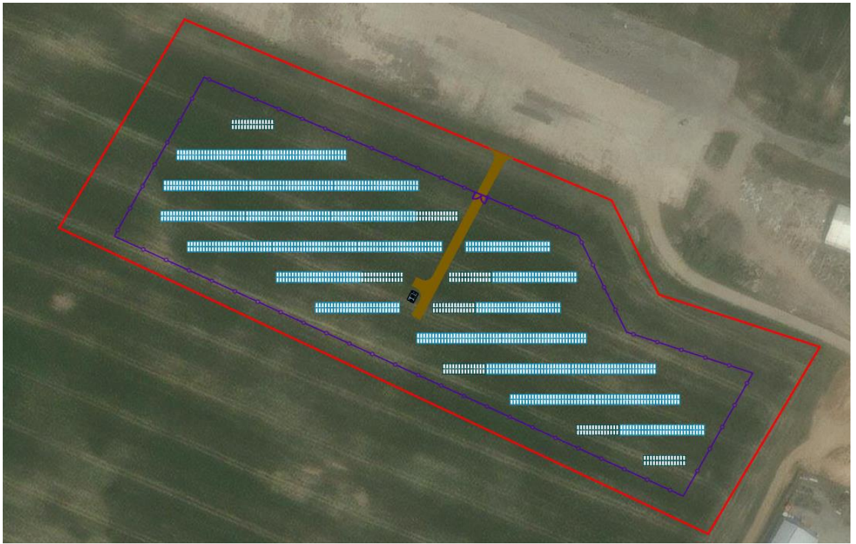
23 pav. 1013,04 kW fiksuoto kampo saulės elektrinė
