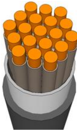
10 pav. Litz kabelio pjūvis[13]
