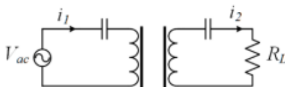
4 pav. Nuosekliai-nuosekliai jungimo topologija[24]
