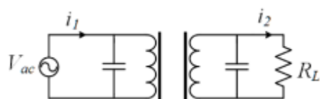
7 pav. Lygiagrečiai- lygiagrečiai jungimo topologija[24]
