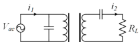
6 pav. Lygiagrečiai-nuosekliai jungimo topologija[24]
