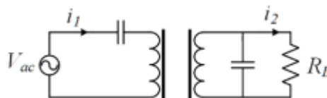
5 pav. Nuosekliai-lygiagrečiai jungimo topologija[24]
