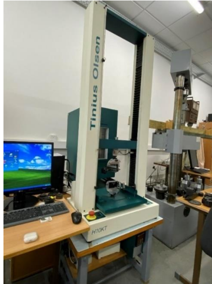
Fig. 14. Tinus Olsen tensile machine
