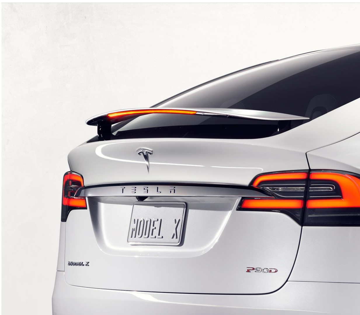
1.5 pav. „Tesla Model X“ aktyvaus tipo galinis aptakas [8]
