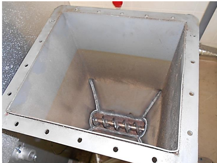
10 pav. Kuro bunkeris su kuro padavimo į pakurą sraigtu
