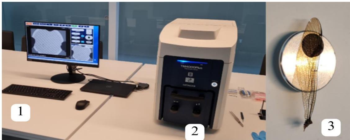
24 pav. SEM tyrimo darbo stendas: 1 – kompiuteris, 2 – skenuojantis elektronų mikroskopas, 3 – tyrimo bandinys
