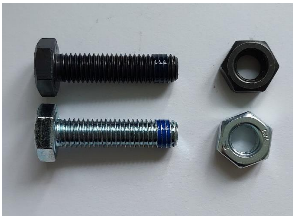
2.4 pav. M10 varžtų padengimas kliais
