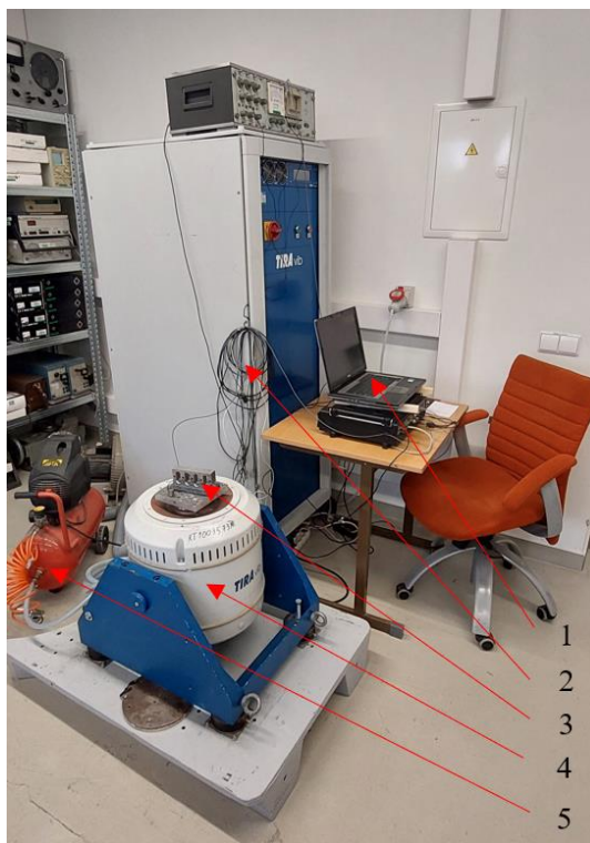
2.10 pav. Dinaminių smūginių apkrovų tyrimo įranga
