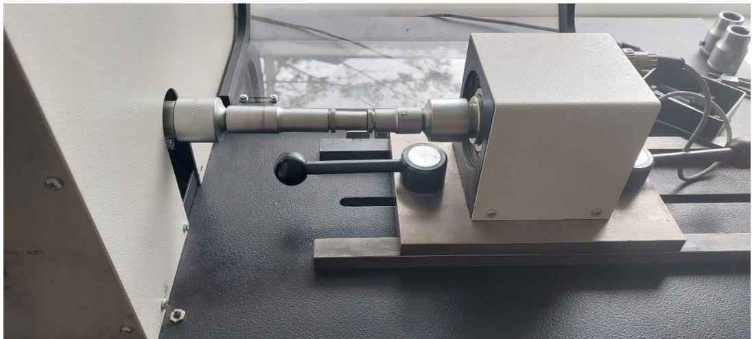
2.11 pav. Smūginių apkrovų tyrimo bandinys įtvirtintas sukimo momento testavimo mašinoje
