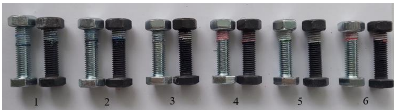
3.5 pav. Irimo sukimo momento patikrinimo tyrimo bandiniai po išardymo
