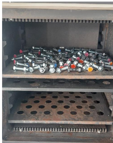
2.7 pav. Bandinių kaitinimas terminėje kameroje
