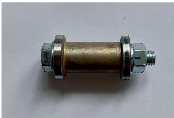
2.9 pav. Smūginių apkrovų bandymo surinktas bandinys
