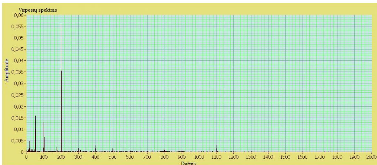
1.1 pav. Tvarkingo vidaus degimo variklio virpesių spektras [3]
