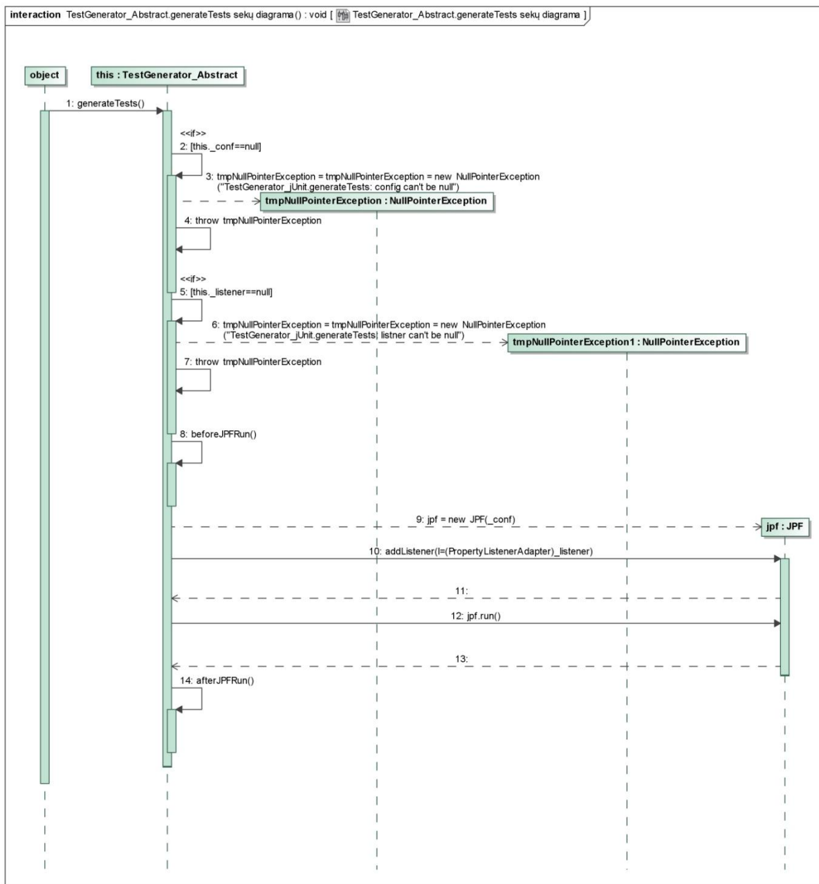
Pav. 16 - TestGenerator_Abstract klasės generateTests() metodo vykdymo sekų diagrama
