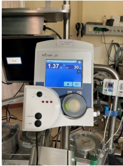
6.2.4 pav. Patentuojamas prietaisas moduliuoti stačiakampes bangas Stocker S5 širdies ir plaučių mašinai, keičiant kraujo srautą
