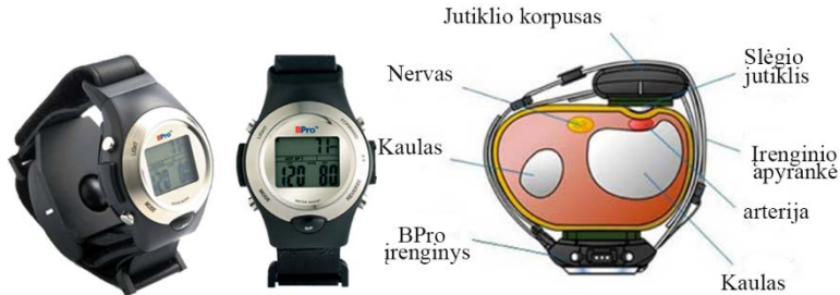
2.7 pav. Tonometrinis metodas yra realizuotas rinkoje esančiame laikrodžio tipo kraujospūdžio registravimo įrenginyje BPro
