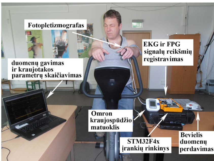
4.8 pav. Eksperimentinio tyrimo metu buvo naudojamas veloergonometras KETTLER, pusiau automatinis kraujospūdžio matavimo įrenginys OMRON ir sukurtas DKPSS prototipas
