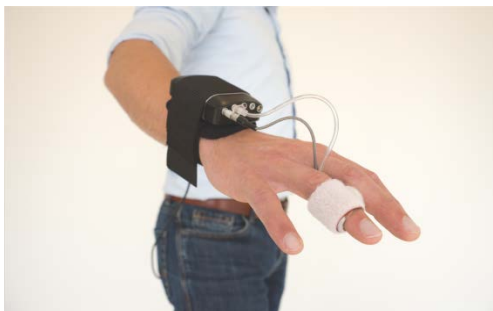
2.9 pav. Tūrio kompensavimo metodą realizuojanti SPB matavimo sistema Finapres Nova
