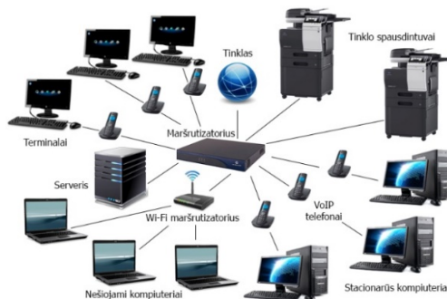
20 pav. Įmonės kompiuterinio tinklo struktūrinė schema
