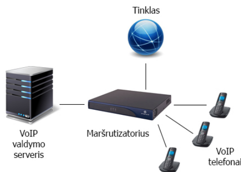
17 pav. IP telefonijos struktūrinė schema
