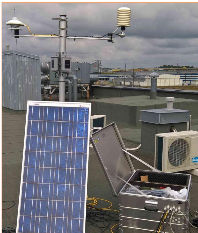
14 Pav. Ant stogo sumontuota oro sąlygų perdavimo stotis
