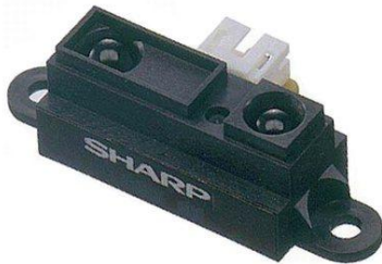
3. pav. Infraraudonųjų spindulių jutiklis, siunčiantis atstumą iki sutiktos kliūties [25]
