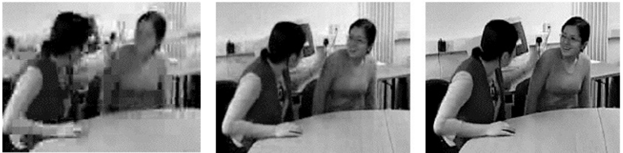
9 pav. Suspaustų video kadro kokybė esant tokiai pat kodavimo spartai naudojant: MPEG-2 (kairėje), MPEG-4 Visual (viduryje), H.264 (dešinėje)
