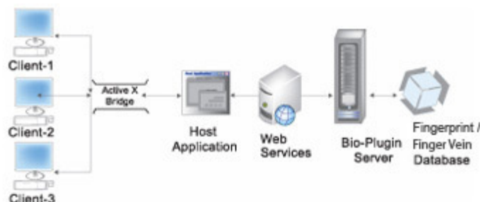
18 pav. Bio-Plugin žiniatinklio serveris: Tai būdas kaip pirštų antspaudų nuskaitymo įrankį integruoti į žiniatinklio platformas.
