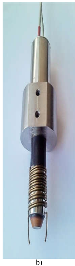
61 pav. Išmanusis talpinis keitiklis: a) struktūrinė schema; b) pagamintas keitiklis
