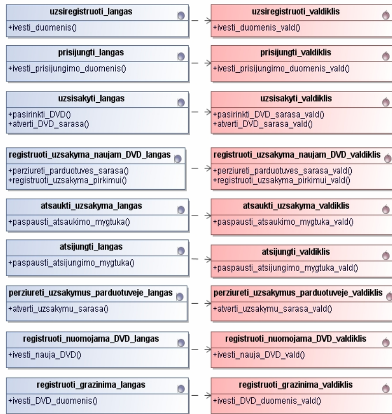
62 pav. Valdymo ir ribinių klasių diagrama
