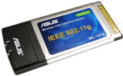
3.3 pav. ASUS WL-107G bevielis Cardbus adapteris
