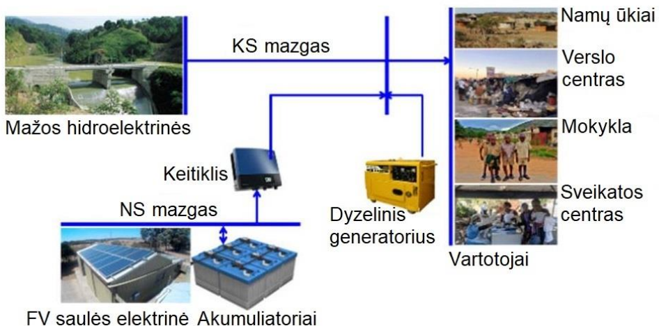
1 pav. Uždarojo elektros mikrotinklo principinės schemos pavyzdys, kai vartotojai naudoja KS elektros energiją (pagal [5] šaltinį)
