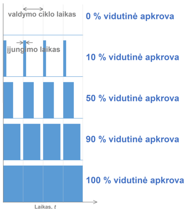
4 pav. Valdymo ciklo ir įjungimo laiko sąvokų vaizdinis paaiškinimas, melsvu grafiku vaizduojama įjungta apkrova
