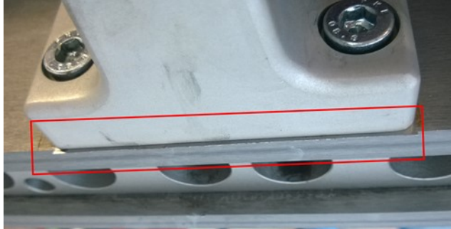
40 pav. Metalo folija (50 \mu\text{m} ) tarp viršutinės rotoriaus stebulės dalies ir likusios konstrukcijos. Tokiu būdu pakeičiamas mentės atakos kampas
