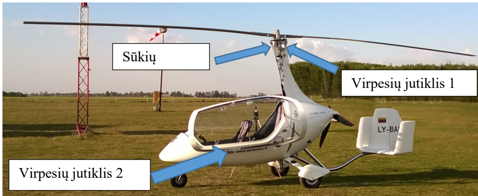
38 pav. Malūnsparnis „Calidus“ ir matuojant naudojamų jutiklių išdėstymo vietas
