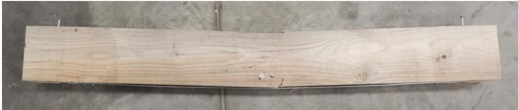
47 pav. Kraštuose savisriegiais suvaržytos plienine juosta armuotos sijos suirimas
