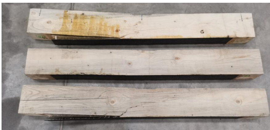
44 pav. Priklijuotu anglies pluoštu armuotų sijų suirimas
