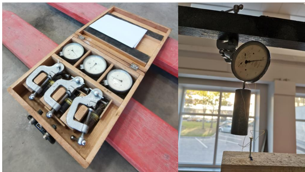
49 pav. Deformacijas matuojančių indikatorių fiksavimas
