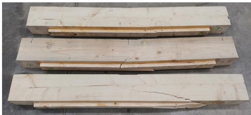
45 pav. Priklijuotu medžio tašu armuotų sijų suirimas
