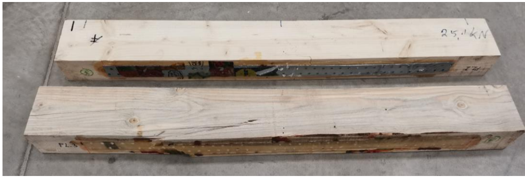
46 pav. Priklijuota plienine juosta armuotų sijų suirimas
