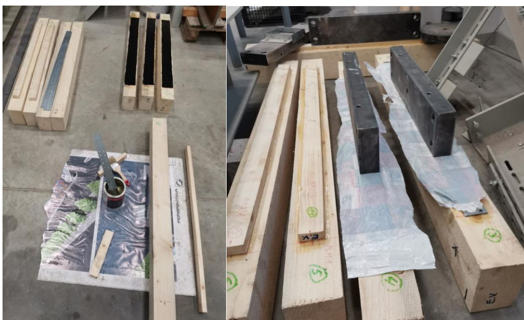
38 pav. Bandinių klijavimas
