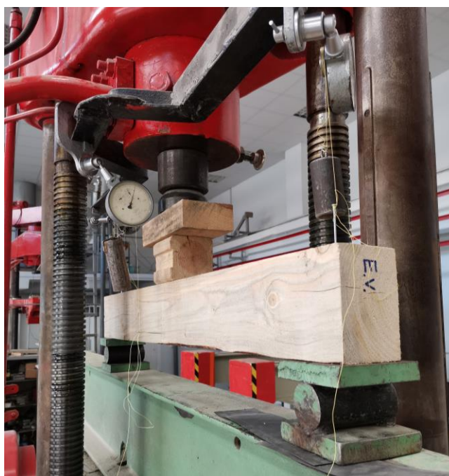
40 pav. Kompozitinio elemento atrėmimas statinio lenkimo mašinoje
