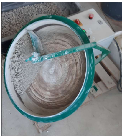
20 pav. Diskinis granulatorius ir jame granuliuojamas užpildas.
