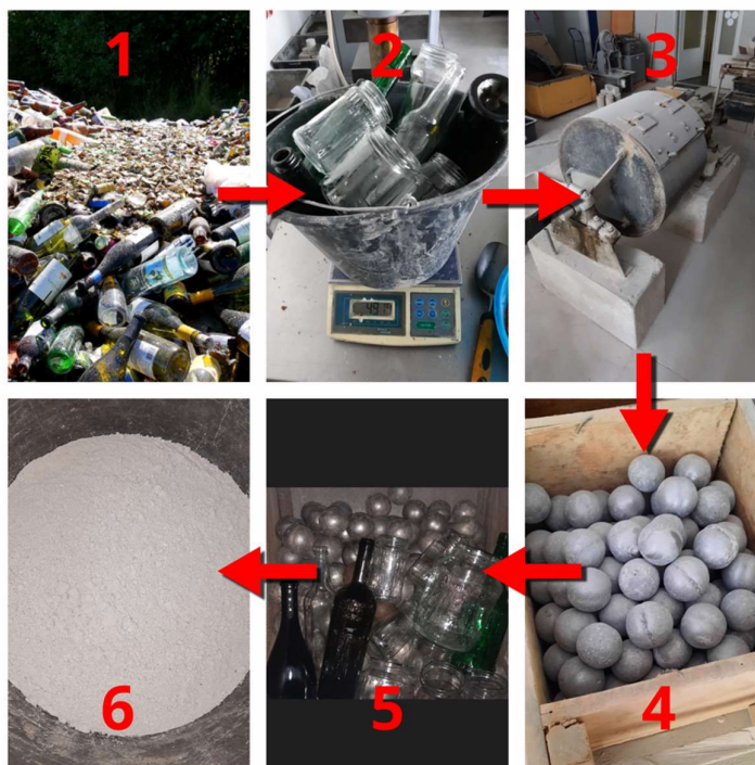
25 pav. Malto stiklo paruošimo technologija (1 – atliekos surinkimas; 2 – ant stiklo esančių nešvarumų pašalinimas; 3,4 – rutulinio malūno ir malimo rutulių paruošimas darbui; 5 – atliekos ir rutulių sudėjimas į malūną; 6 – žaliavos gavimas) (sudaryta autoriaus).
