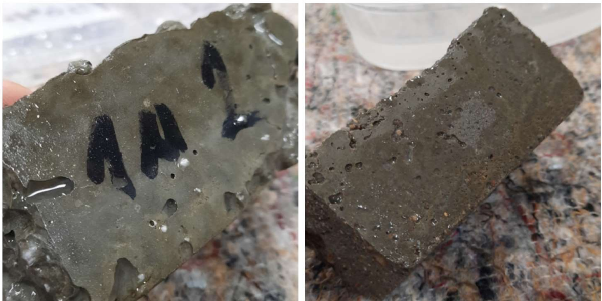
38 pav. Kairėje prizmelė C20S80 be smulkaus užpildo, dešinėje prizmelė C20S80 su smulkiu užpildu .
