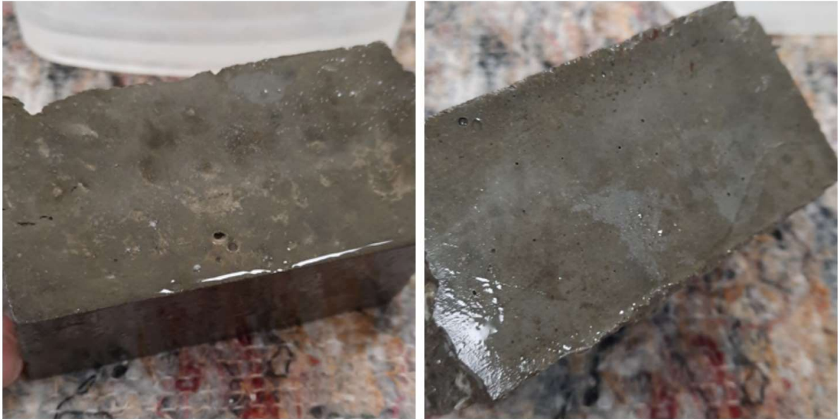
39 pav. Kairėje prizmelė C5K15S80 be smulkaus užpildo, dešinėje prizmelė C5K15S80 su smulkiu užpildu.
