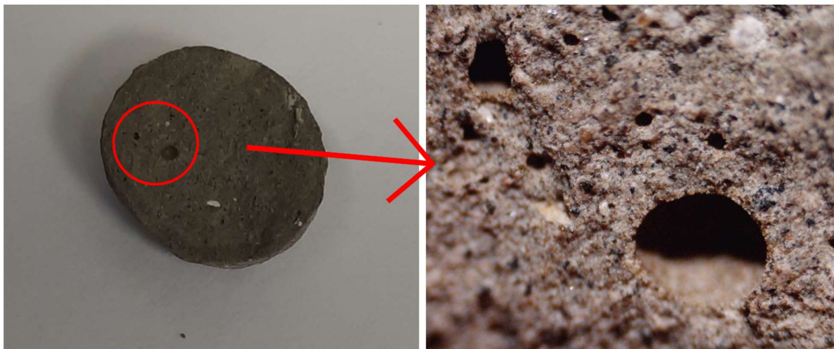
31 pav. Dirbtinio užpildo Nr.1 (C100) skerspjūvis.
