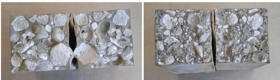
44 pav. Bandinio Nr. 3 (5C15K80S) skerspjūvis per suirimo vietą po lenkimo bandymo (kairėje prizmelė be smulkaus užpildo, dešinėje prizmelė su smulkiu užpildu).
