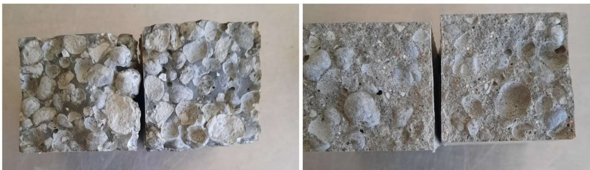
43 pav. Bandinio Nr. 2 (20C80S) skerspjūvis per suirimo vietą po lenkimo bandymo (kairėje prizmelė be smulkaus užpildo, dešinėje prizmelė su smulkiu užpildu).
