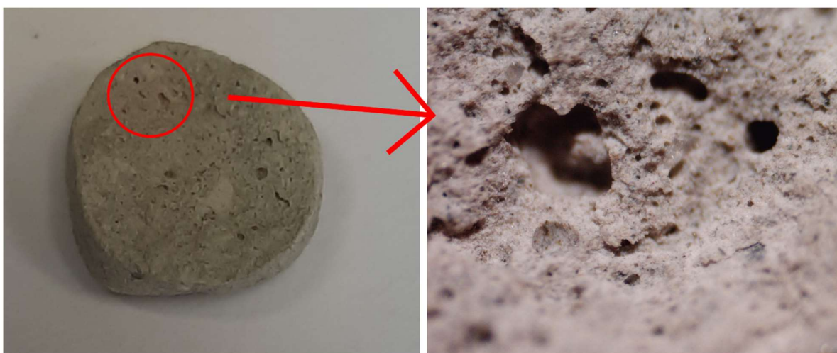
33 pav. Dirbtinio užpildo Nr.3 (C5K15S80) skerspjūvis.
