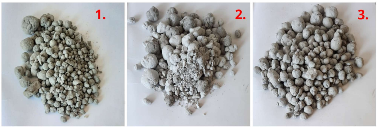
28 pav. Granuliatoriumi pagaminti dirbtiniai užpildai (Nr.1 – C100, Nr.2 – C20S80, Nr.3 – C5K15S80).
