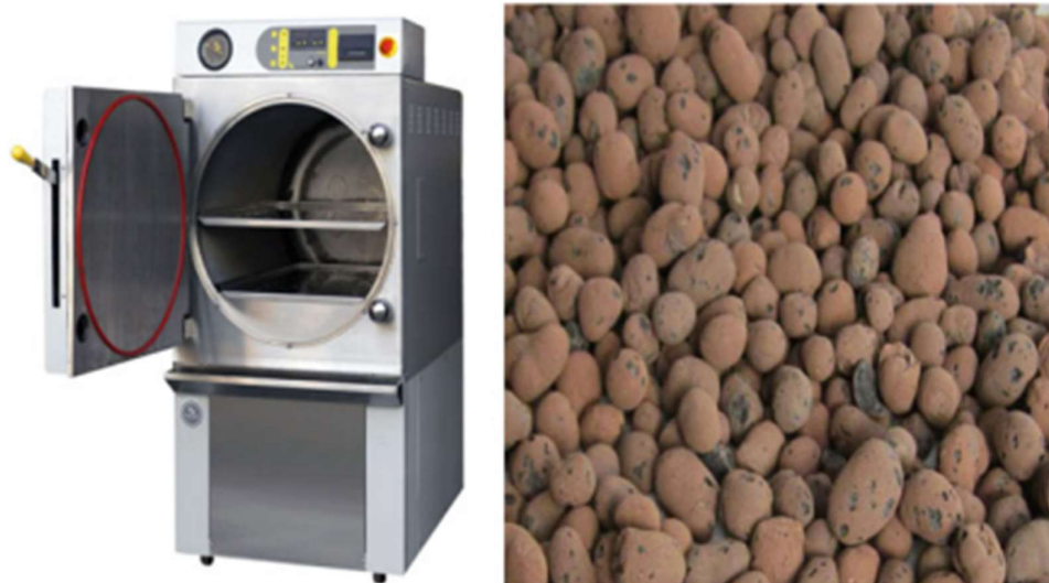
12 pav. Autoklavinė kamera ir joje gautas dirbtinis užpildas [28]
