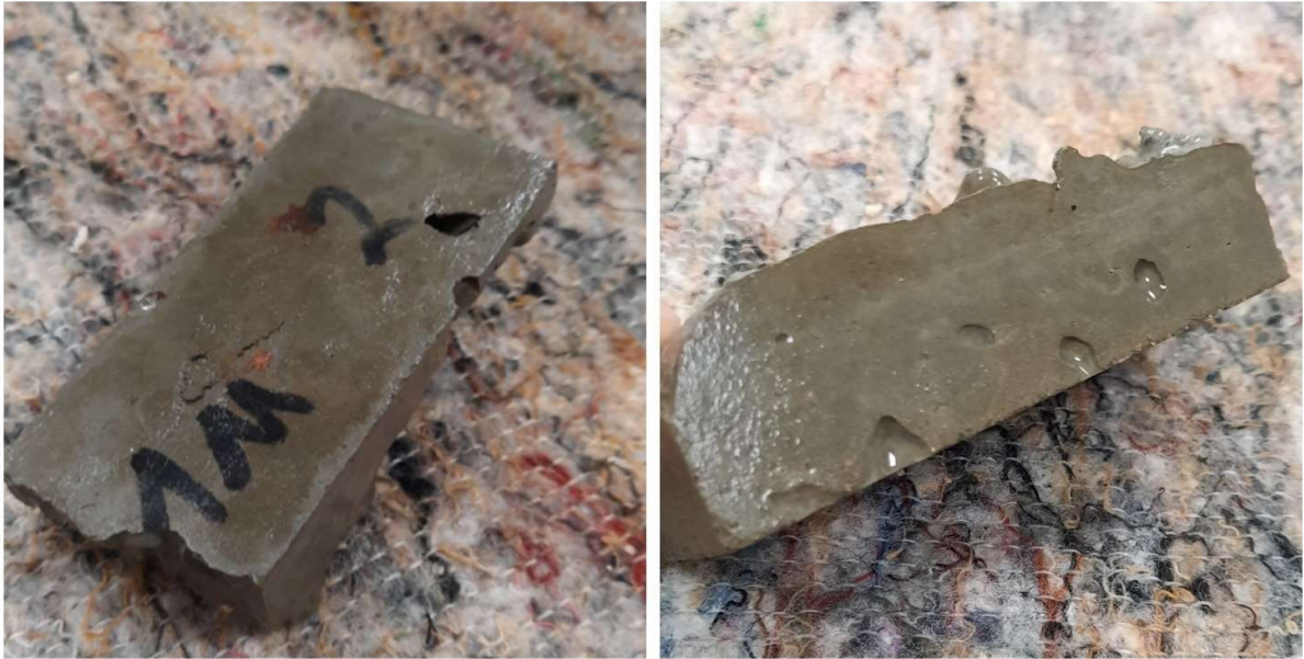
37 pav. Kairėje prizmelė C100 be smulkaus užpildo, dešinėje prizmelė C100 su smulkiu užpildu .
