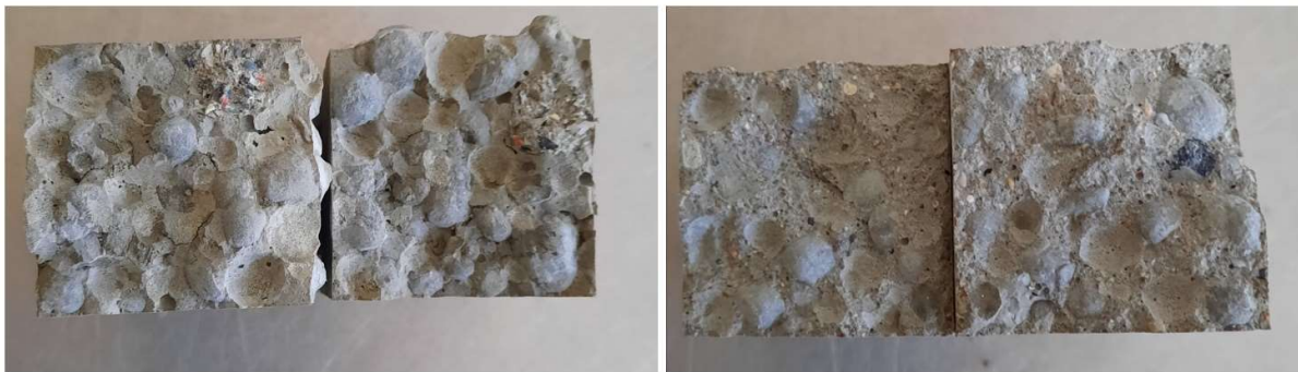
42 pav. Bandinio Nr. 1 (100C) skerspjūvis per suirimo vietą po lenkimo bandymo (kairėje prizmelė be smulkaus užpildo, dešinėje prizmelė su smulkiu užpildu).
