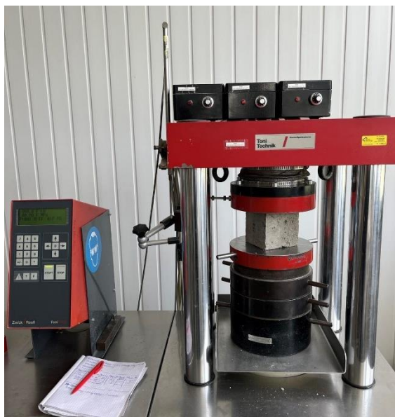
23 pav. Gniuždymo bandymui naudojama mašina „Tony Technik“
