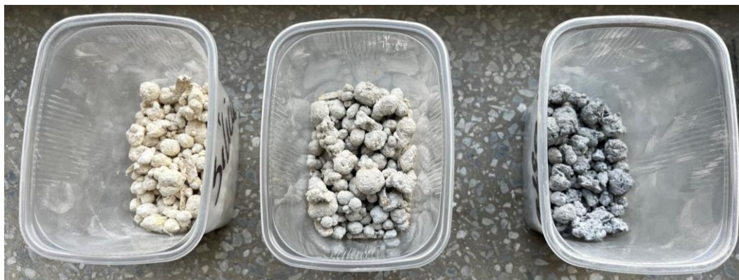
29 pav. Užpildai prieš atsparumo šalčiui bandymą: pjuvenų ir gesintų kalkių užpildas (kairėje), pjuvenų, gesintų kalkių ir portlandcemenčio užpildas (viduryje), pirolizuotos medienos ir gesintų kalkių užpildas (dešinėje)
