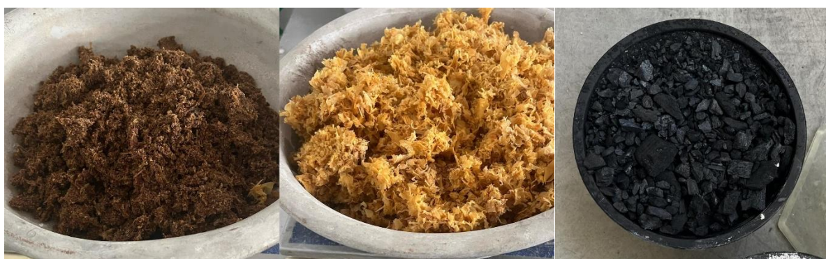
16 pav. Naudotos organinės medžiagos: smulkios ir stambios spygliuočių pjuvenos, pirolizuota mediena
