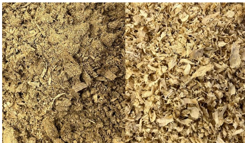
17 pav. Pjuvenos po džiovinimo – smulkios (kairėje) ir stambios (dešinėje)
