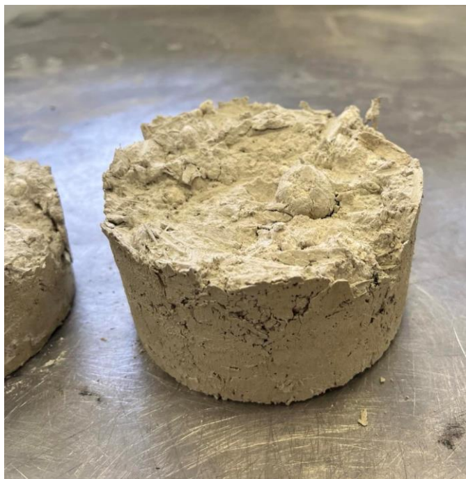
36 pav. Presuoto biokompozito skerspjūvis po gniuždymo bandymo
