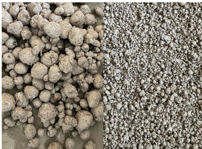
19 pav. Užpildas su per dideliu vandens kiekiu (kairėje), užpildas su reikiamu vandens kiekiu (dešinėje)
