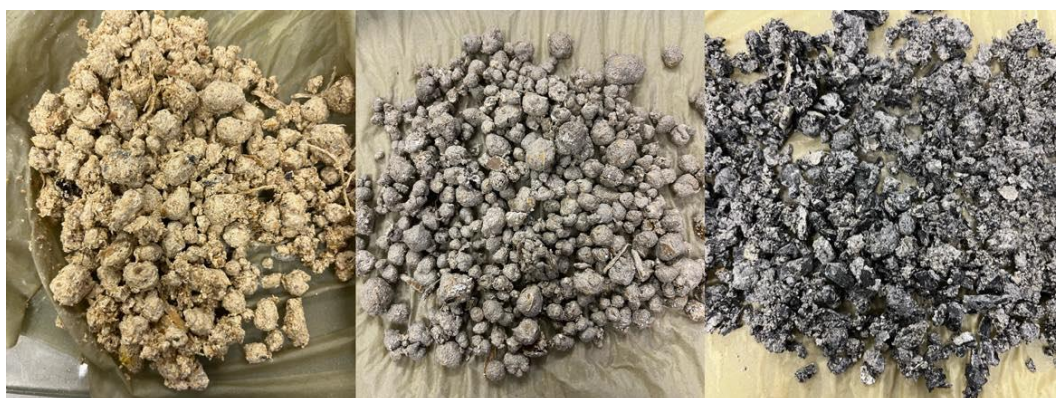
30 pav. Užpildai po atsparumo šalčiui bandymo: pjuvenų ir gesintų kalkių užpildas (kairėje), pjuvenų, gesintų kalkių ir portlandcemenčio užpildas (viduryje), pirolizuotos medienos ir gesintų kalkių užpildas (dešinėje)
