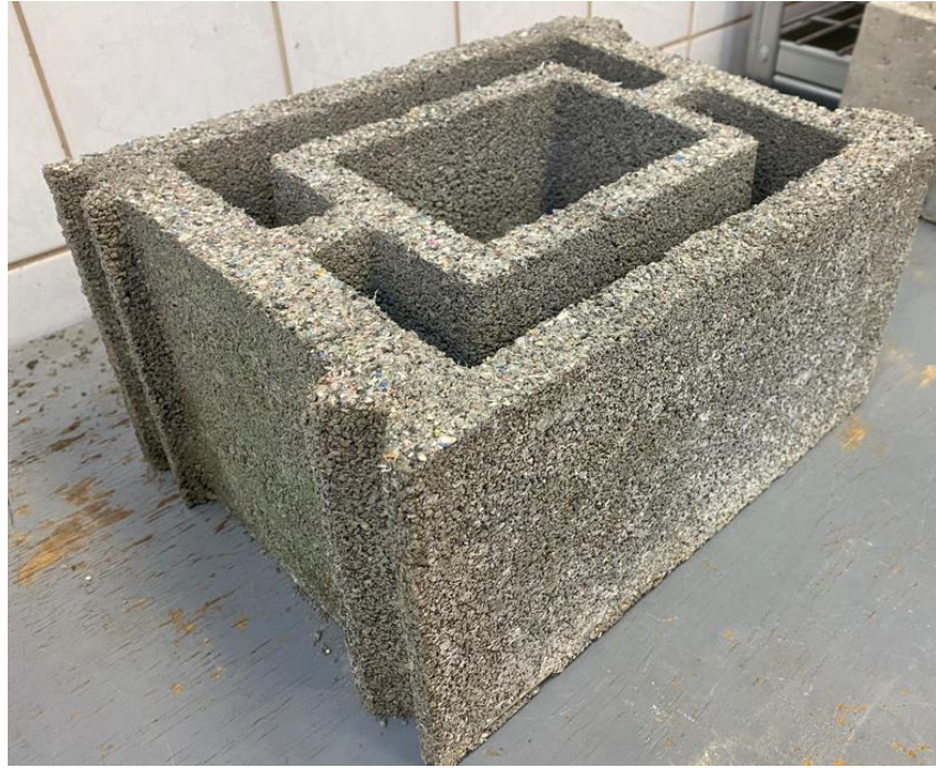
3.6.12 pav. Betoninis blokelis su grynomis plastiko atliekomis
