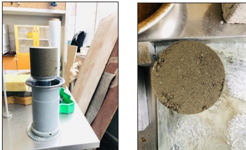
Fig. 26. W/C:0.30 Visual Analysing test
