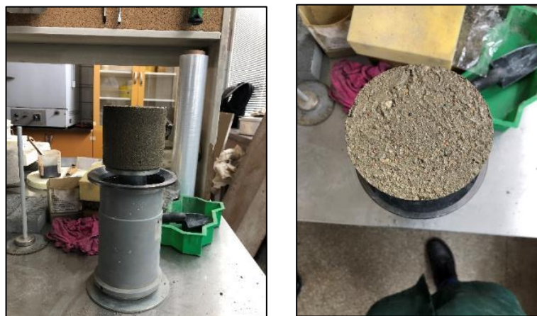
Fig. 29. W/C:0.45 Visual Analysing test
