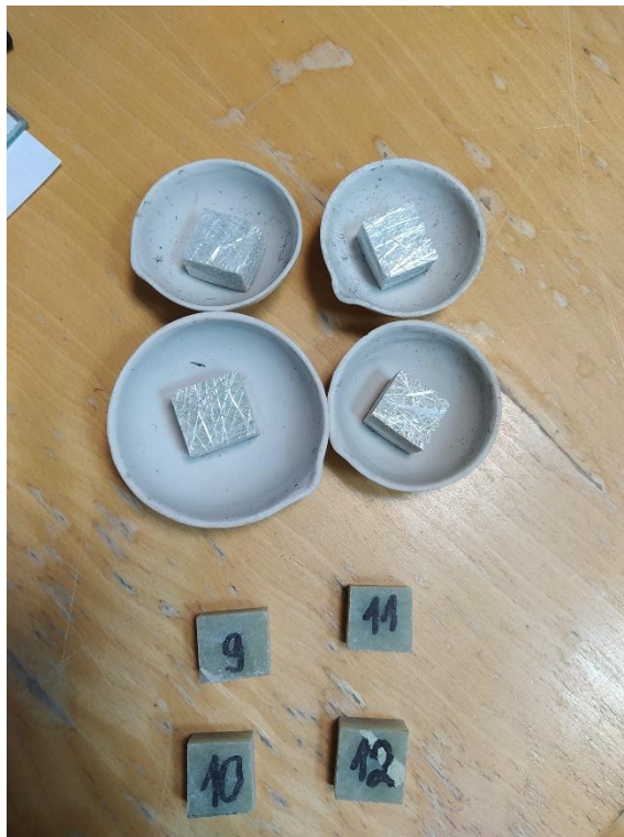
18 pav. Bandiniai prieš ir po bandymo išdeginti
