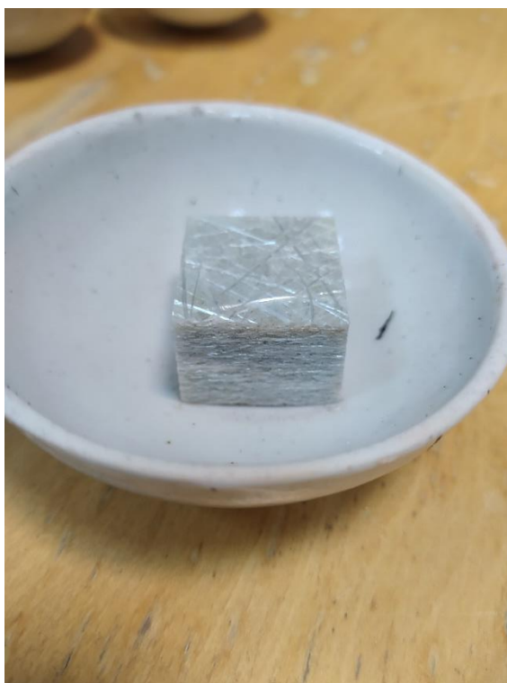
19 pav. Po nepavykusio deginimo bandymo likęs stiklo pluoštas
