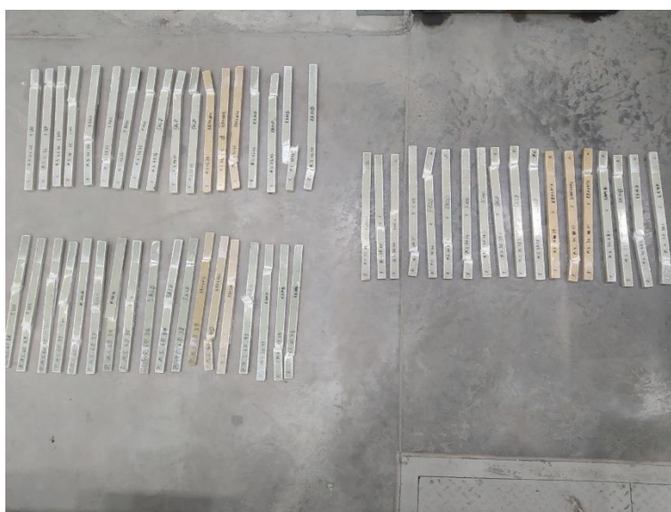
13 pav. Visi bandiniai po tempimo bandymo
