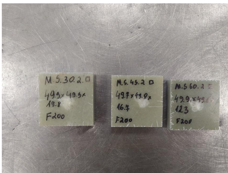
24 pav. Bandiniai po 10 smūgių.
