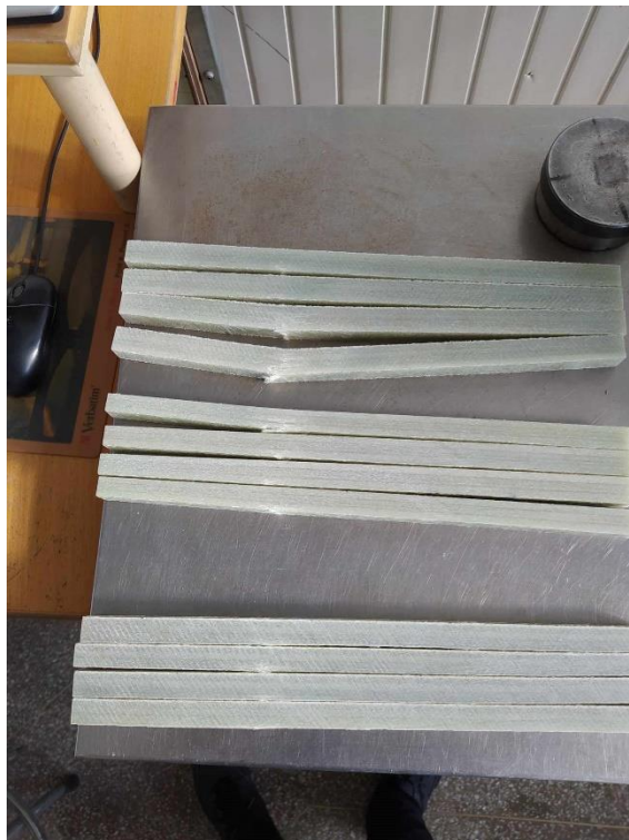
5 pav. Bandiniai po lenkimo bandymo
