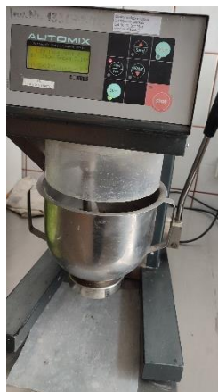
25 pav. Mišinių maišyklė „Automix 65-L0006A“, tūris - 3l
