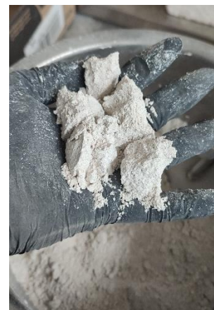
28 pav. Suspausto standaus suirimas į jį dūrus pirštu
