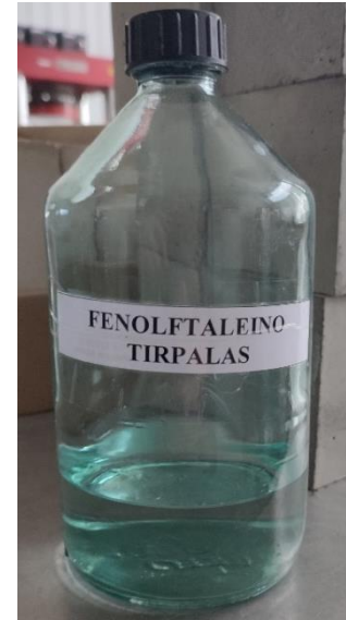
34 pav. Fenolftaleino tirpalas - pH indikatorius
