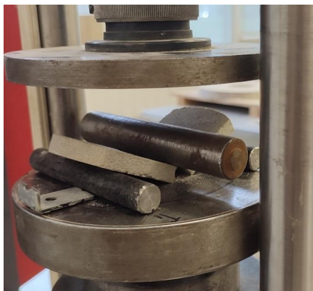
54 pav. Suiręs bandinys pasiekęs didžiausią ardomąją apkrovą
