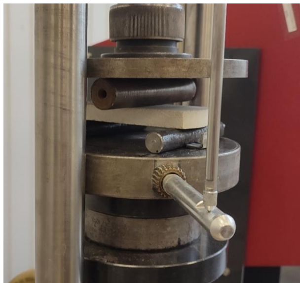
53 pav. Lenkimo bandymui paruoštas bandinys
