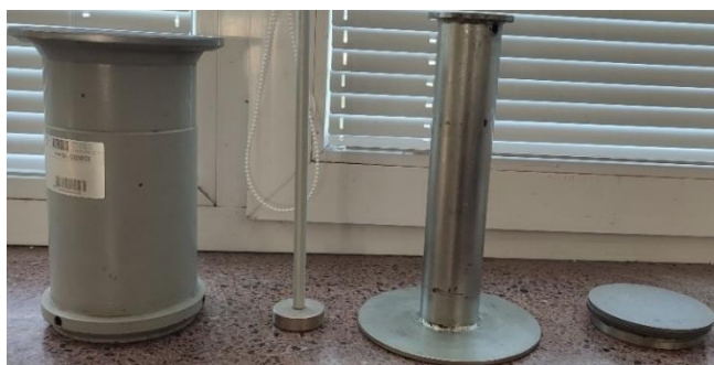
31 pav. Specialus giratoriaus presavimo indas
