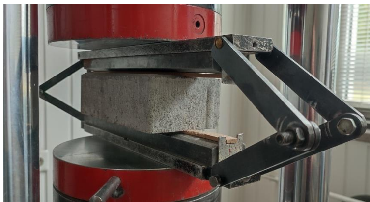
36 pav. Skėlimo bandymas naudojantis presu
