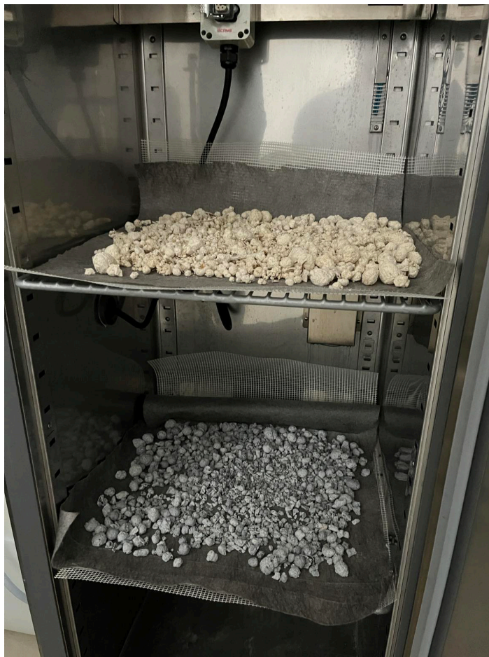
18 pav. Lengvieji užpildai anglies dioksido kamerą (apačioje Nr. 2, viršuje Nr. 3 užpildai)
