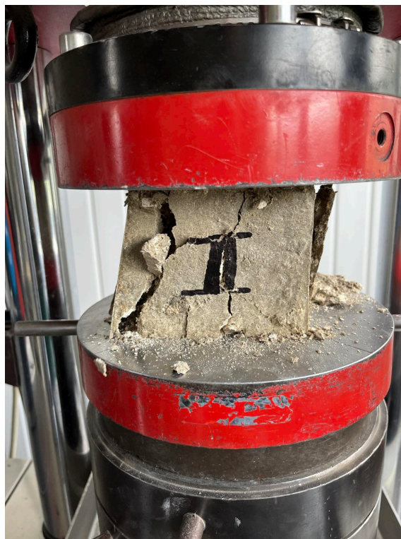
13 pav. Gniuždomojo stiprio nustatymas su gniuždymo mašina
