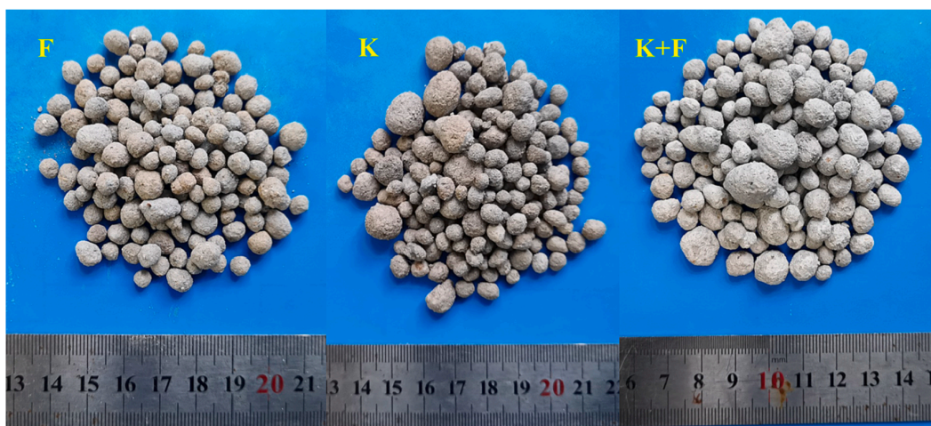
8 pav. Skirtingų sudėčių ir dydžių dirbtiniai užpildai [25]
