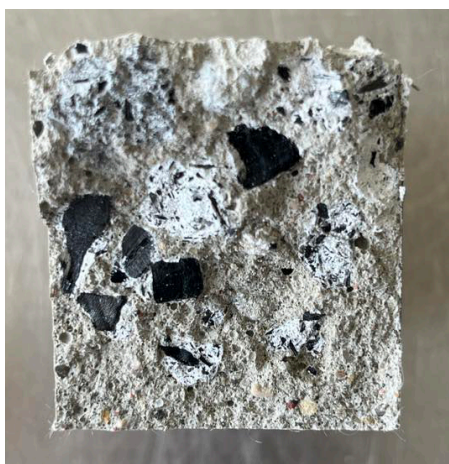
28 pav. 3D spausdinimo mišinio struktūra su stambiu užpildu
