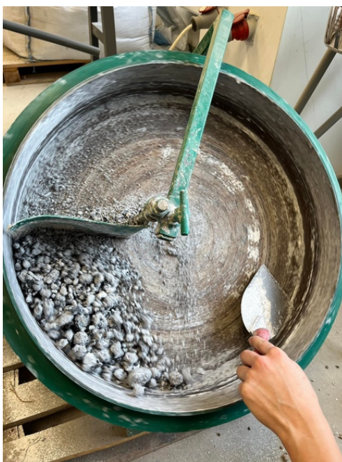
11 pav. Granuliavimo aparatas
