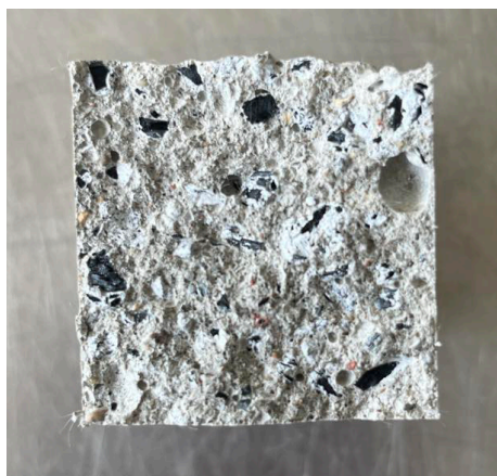
27 pav. 3D spausdinimo mišinio struktūra su smulkiu užpildu
