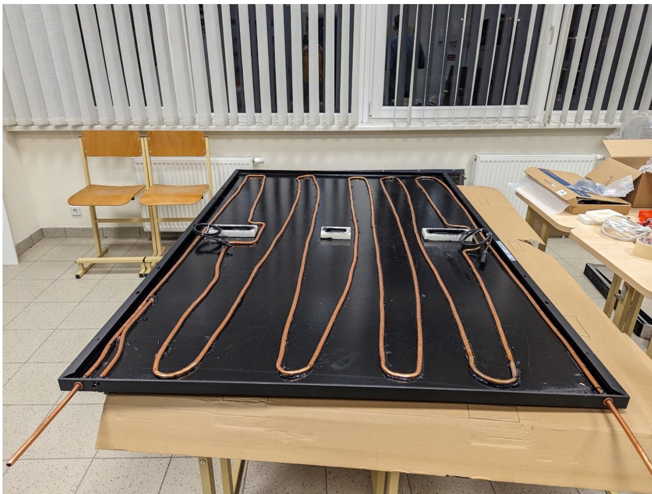
18 pav. Laboratorijoje sukonstruotas hibridinio saulės kolektoriaus modulis
