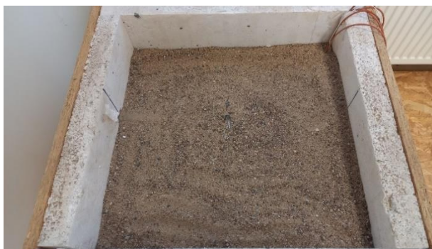
18 pav. Užpildytas laboratorinis stendas sausu smulkios frakcijos žvyru
