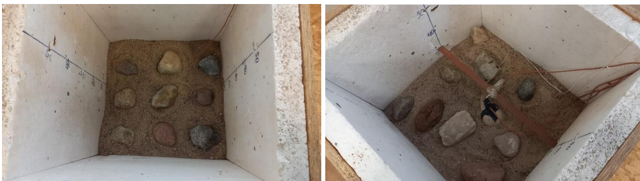
20 pav. Kairėje akmenų išdėstymas pirmajame užpildo sluoknyje laboratoriniam tyrimui, dešinėje – akmenų su temperatūros jutikliais padėtis stendo viduje
