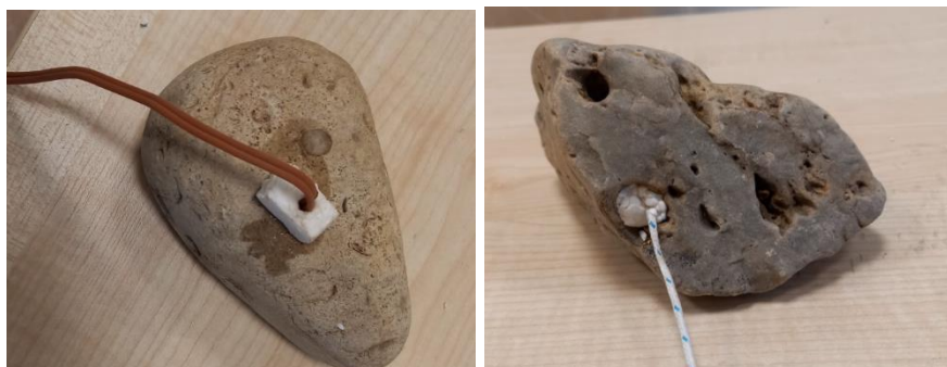
21 pav. Temperatūros jutiklių pozicija akmenyse
