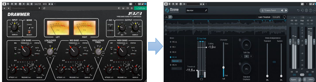
21 pav. Garso apipavidalinimo grandinės pavyzdys
