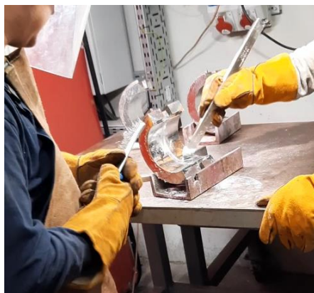
22 pav. Alavo strypelio trynimasis lygiagrečiai atliekant flusavimą
