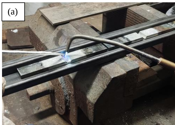
31 pav. Liejimo, naudojant atvirą liepsną, pirminės procedūros eiga: (a) – šaknies formavimas, (b) – galų uždarymas
