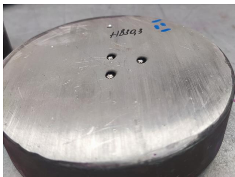
50 pav. Babito „U“ formos tipo bandinys po PMI tyrimo
