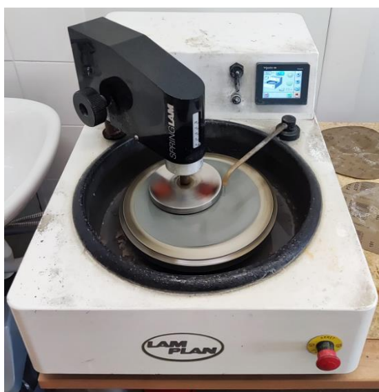
66 pav. Automatinis šlifavimo ir poliravimo įrenginys „Lam Plan“
