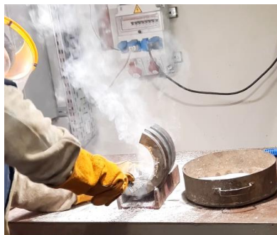
20 pav. Amonio fluorida miltelių trynimasis flusavimo metu
