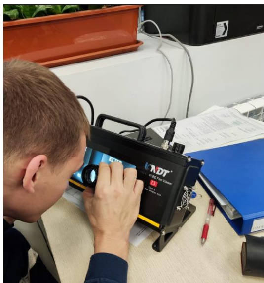
62 pav. Rentgenogramos analizė po ryškinimo
