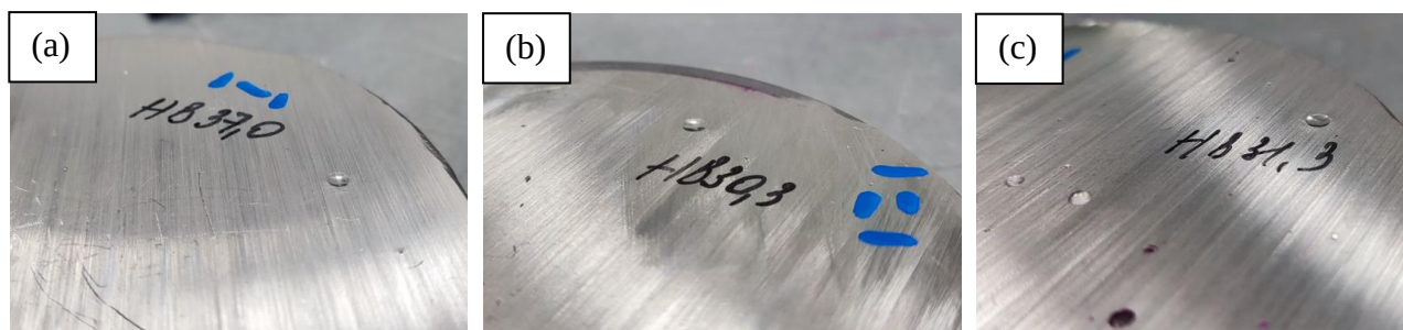
48 pav. Babito bandiniai po kietumo matavimų: (a) – AR bandinio kietumas, (b) – GA bandinio kietumas, (c) – TIG bandinio kietumas
