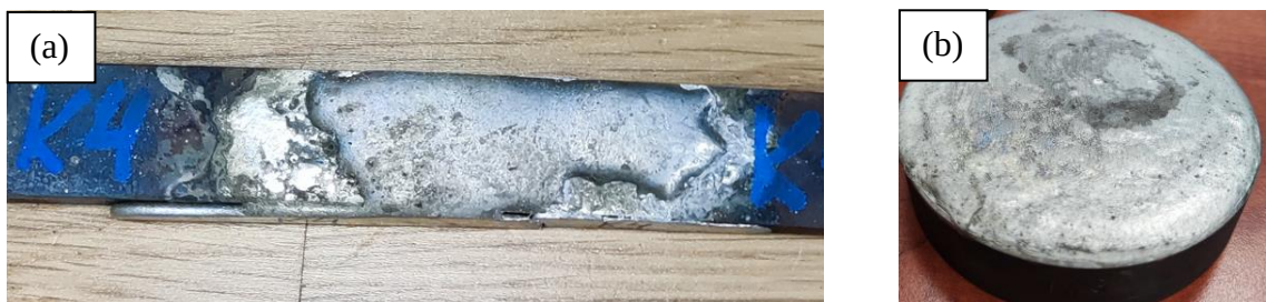
29 pav. Bandiniai gauti tiesioginio liejimo metu: (a) – V formos tipo „K“ bandinys, (b) – U formos tipo „TIG“ bandinys
