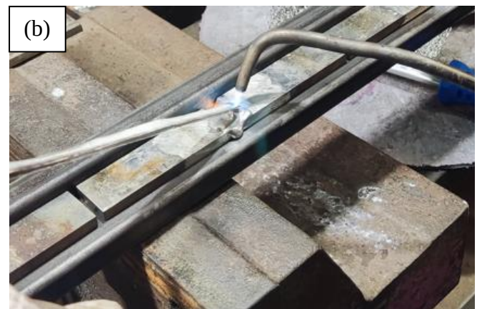
31 pav. Liejimo, naudojant atvirą liepsną, pirminės procedūros eiga: (a) – šaknies formavimas, (b) – galų uždarymas
