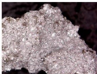
3 pav. Babito B-83 medžiagos vidaus struktūra po laužimo
