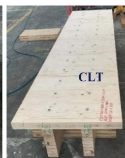
5 pav. Medžio kompozito sijų (perdangų) jungtis su kolona [27]: a) TTC matmenys ir detalės ir b) TTC sijos ir plieninės kolonos mazgas, c) TTC su kolonos išsiskverbimu į CLT plokštę ir išsiskverbimo geometrija, d) be kolonos išsiskverbimo į CLT plokštę.
