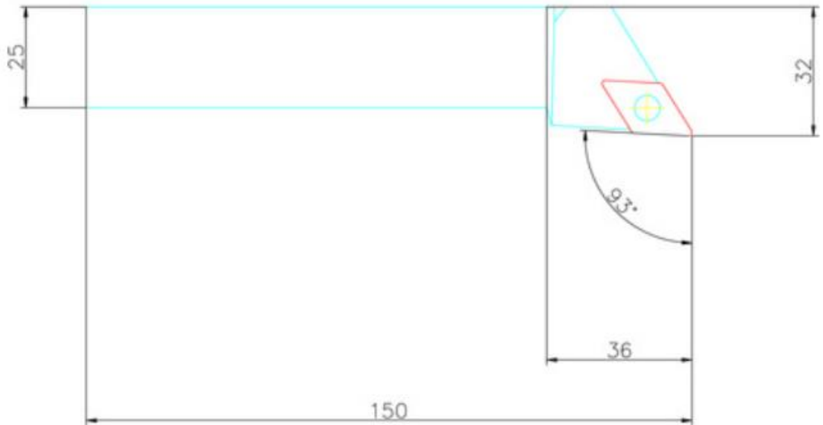
12 pav. Plokštelių laikiklio PDJRN/L 2525M15 vizualizacija
