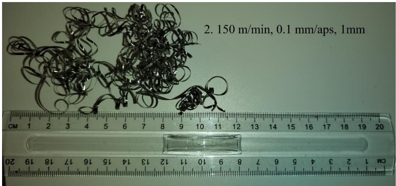
24 pav. Eksperimento nr 2. drožlė
