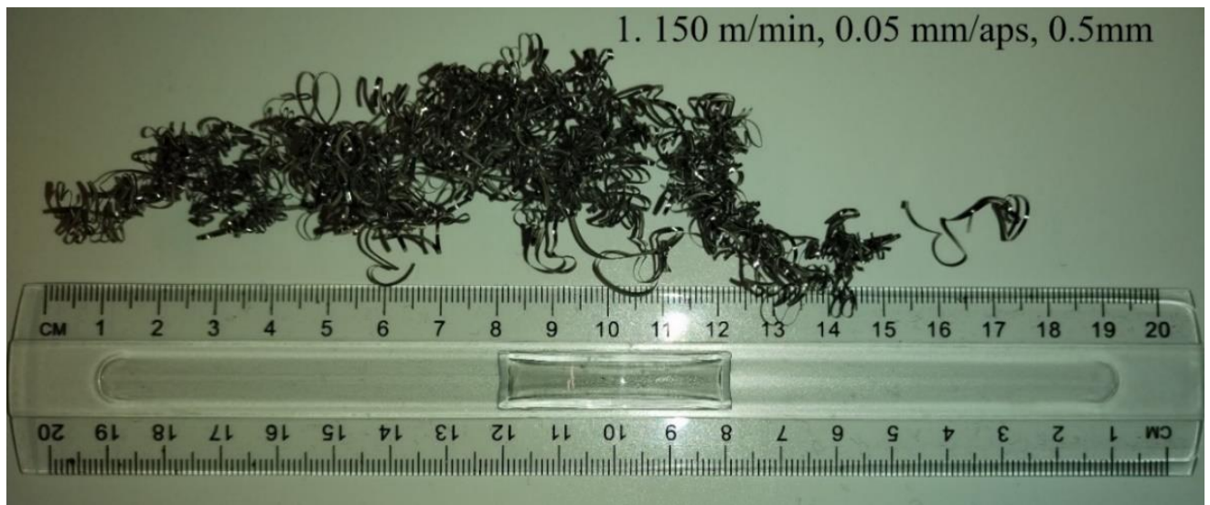
23 pav. Eksperimento nr.1 drožlė
