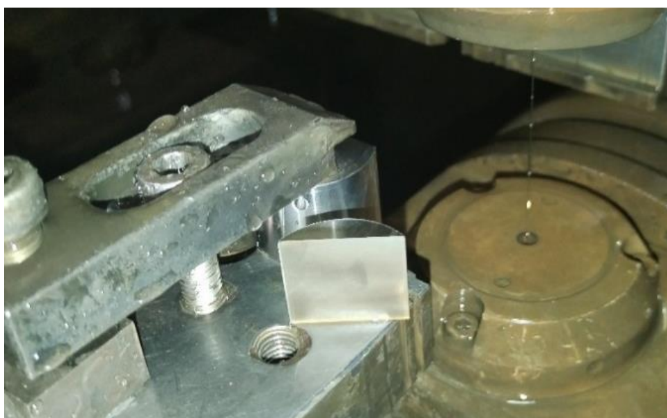
17 pav. Perpjautas bandinys elektroerozinio pjovimo viela staklėse
