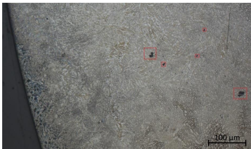
35 pav. Duplex 1.4462 mikrostruktūra padidinta 5 kartais
