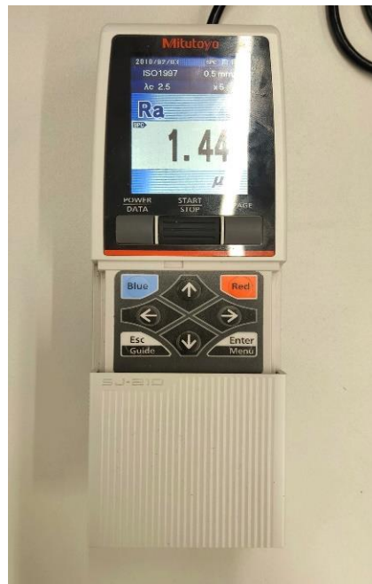
10 pav. Šiurkštomatis Mitutoyo SJ-210
