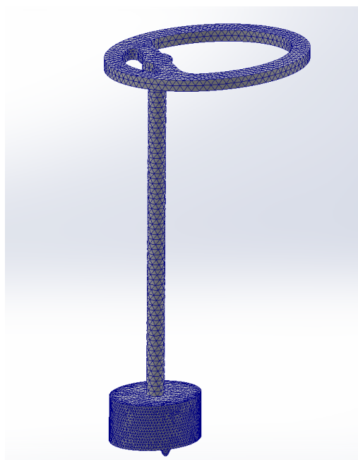
29 pav. Protezo C variacijos baigtinių elementų tinklelis modalinei analizei
