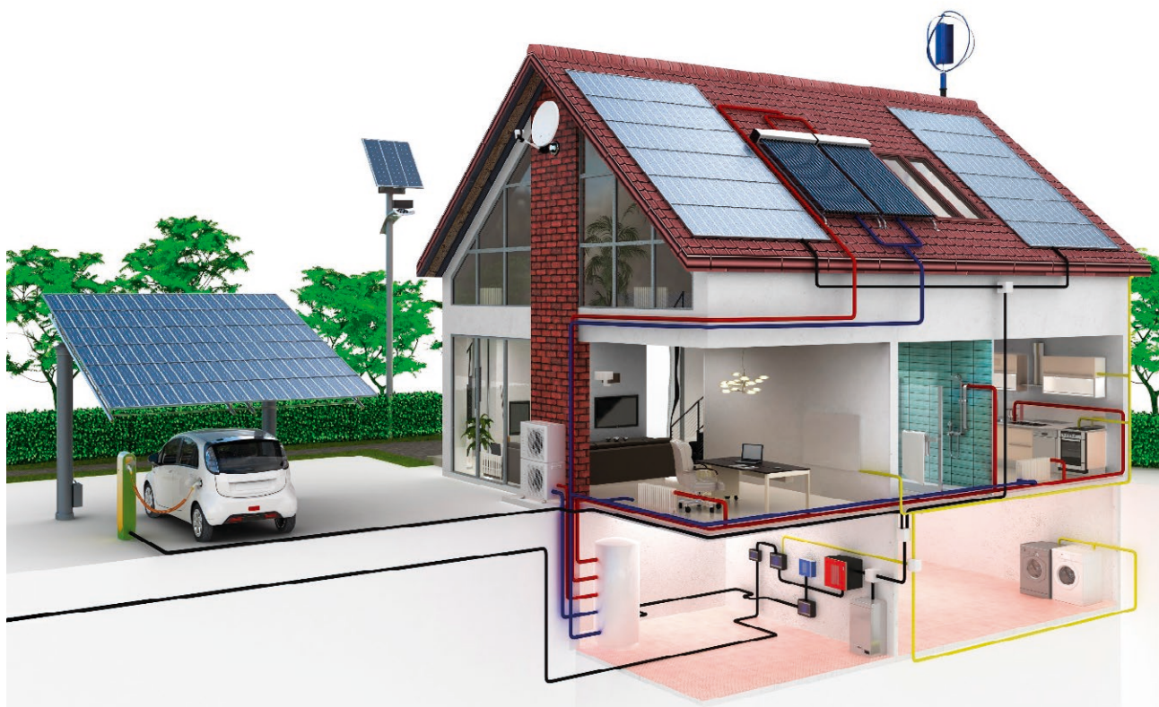
1 pav. Namas, kuriame įrengta šilumos siurblių ir fotovoltinės elektrinės šildymo sistema Šaltinis: © Lietuvos saulės energetikos asociacija.
