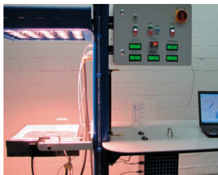
5 pav. Valdymo skydelis saulės kolektoriaus modulyje Šaltinis: ET 202 Energy and Environment, GUNT Hamburg
