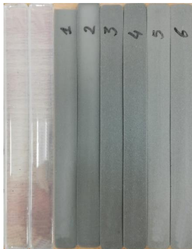
30 pav. Bandinių, naudotų mechaninių savybių tyrimui, nuotrauka: iš kairės balti (permatomi) gryno silikono bandiniai, 1 ir 2 – 0,8 mmol/g daugiasluoksniai bandiniai, 3 ir 4 – 1,6 mmol/g daugiasluoksniai bandiniai, 5 ir 6 – 3,2 mmol/g daugiasluoksniai bandiniai [128]
