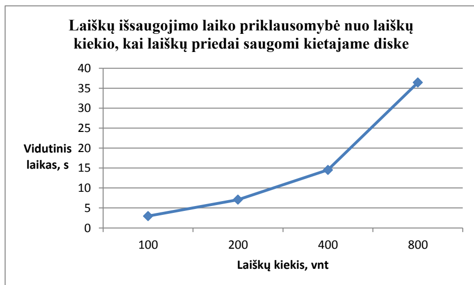
15 pav. Laiškų išsaugojimo laiko priklausomybė nuo laiškų kiekio, kai laiškų priedai saugomi kietajame diske
