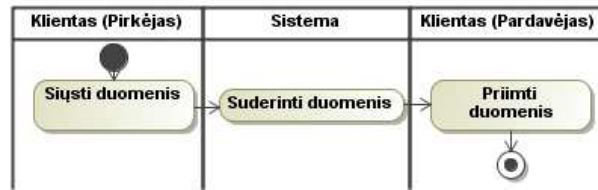
3.3 pav. Verslo taisyklių suderinimo įmonių sąveikumo sprendimuose veiklos proceso diagrama
