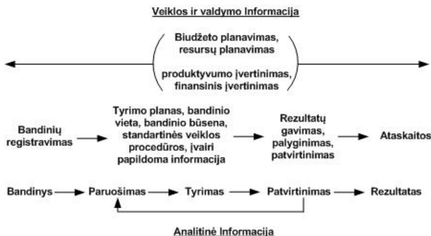
2.4 pav. Detalesnė principinė analitinės laboratorijos duomenų srauto schema
