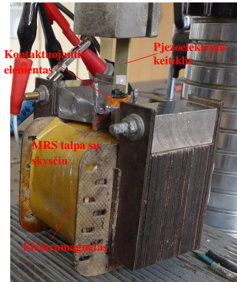
3.22 pav. Panardinto pjezoelektrinio keitiklio magnetoreologiniame skystyje išorinis vaizdas
