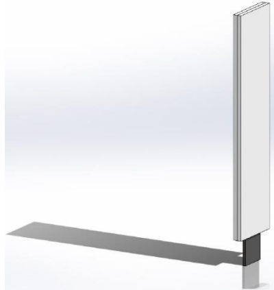
3.18 pav. Pjezoelektrinio keitiklio kontaktuojančio elemento geometrinė forma, veikianti vožtuvo režimu, projektuota SolidWorks inžinerinio projektavimo paketu.
