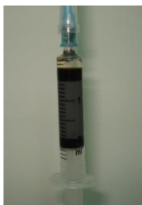
4.5 pav. Magnetoreologinis skystis MRF – 140CG. Sedimentacijos trukmė 336 valandas
