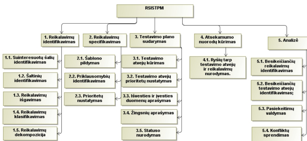
15 pav. Reikalavimų specifikacijos integralumo su testavimo procesu modelis
