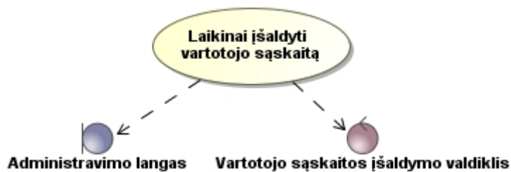
32 pav.: Panaudojimo atvejo „Laikinaai iššaldyti vartotojo sąskaitą“ analizės diagrama
