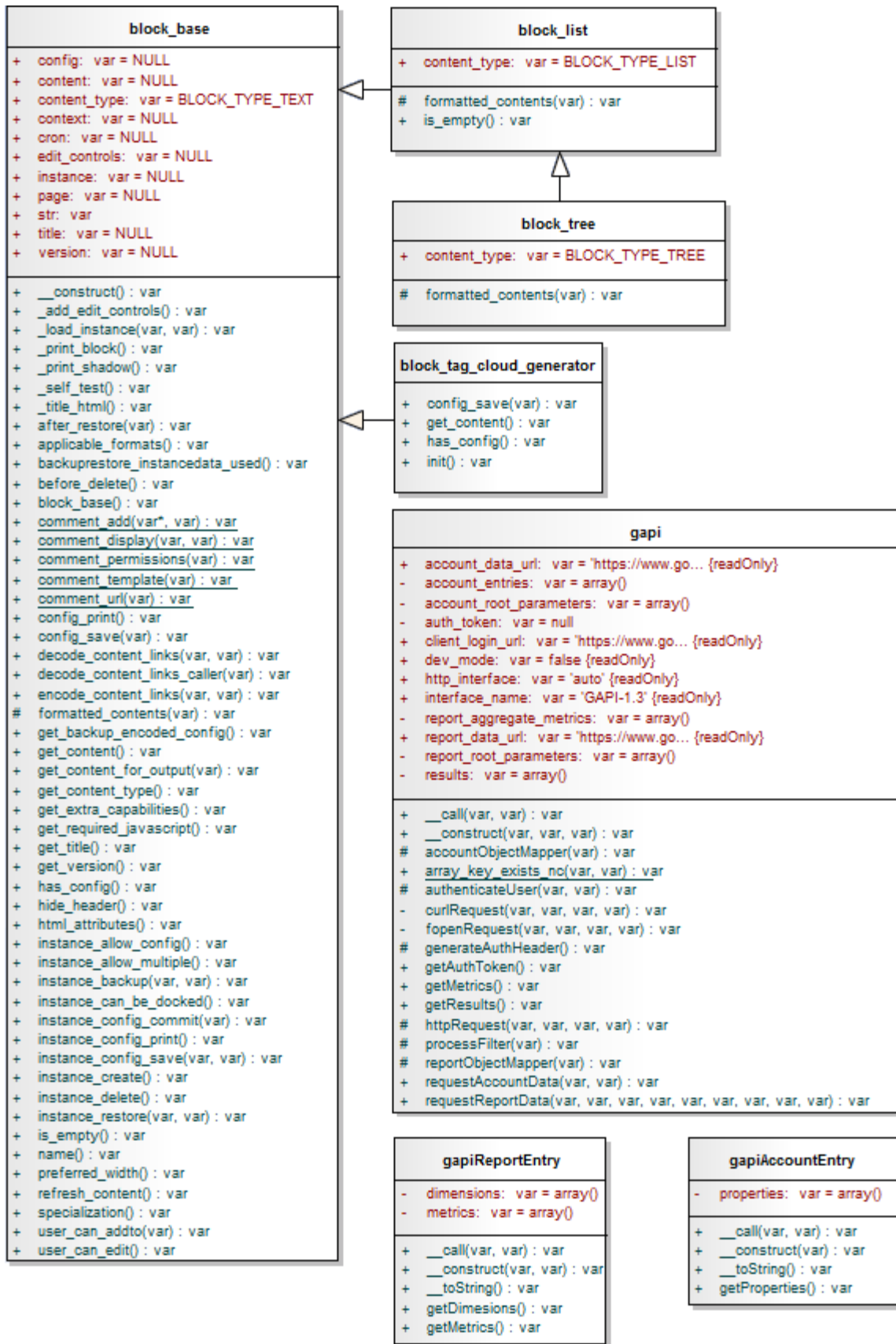
2.13 pav. Klasių, skirtų žymių „debesies“ generavimo įrankiu realizuoti, diagrama
