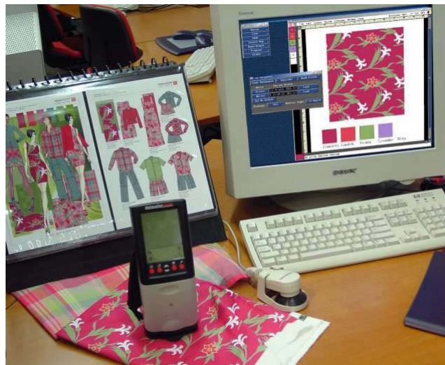
3 pav. „Lectra system“ sistema, tekstūrų atpažinimas iš realios medžiagos ir panaudojimas modelyje.(13)
