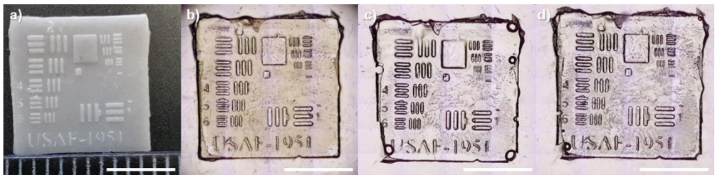
12 pav. \mu TM rezultatai: (a) išspausdinto 1951 USAF šablono nuotrauka; (b) PDMS štapavimo formos nuotrauka; (c) ir (d) E1 ir E8 dervų replikų nuotraukos. Brūkšniai nuotraukose atitinka 5 mm
